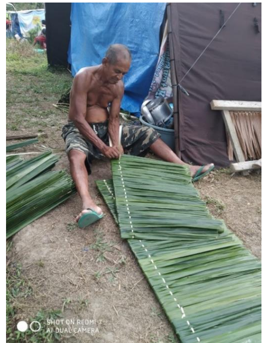
Dakbedekking in de maak, van atap, aangeregen sagopalmladeren, als vervanging van de kapotte tentzeildoek. Traditionele oude ambacht is weer terug. 24 oktober 2019
